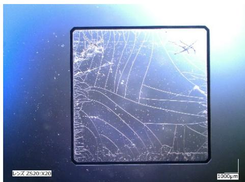
図6: 80MeV  $\text{I}^{13+}$  を  $1 \times 10^{12}/\text{cm}^2$  照射した非晶質シリカの光学顕微鏡像。応力により全面にクラックが入っている。
