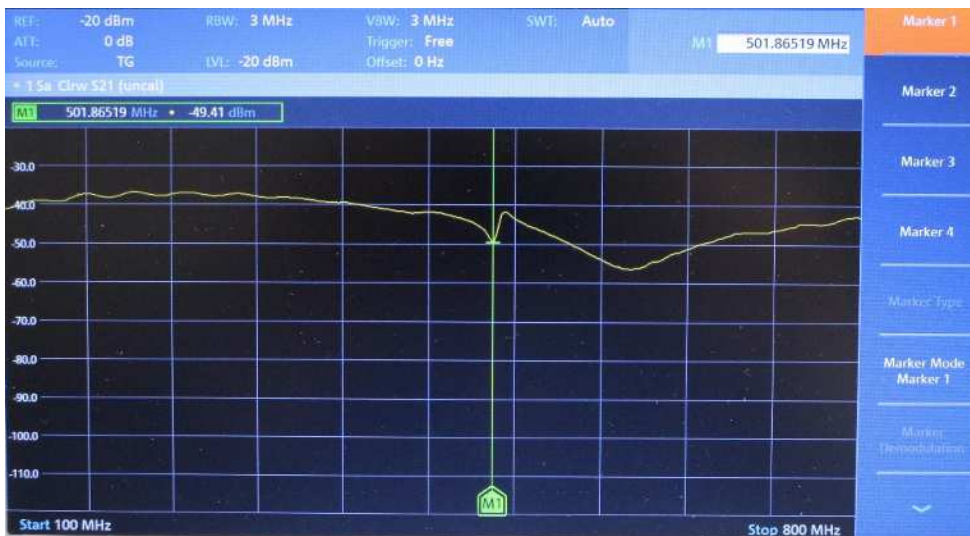
スペクトラムアナライザによる共振周波数における dip の確認
