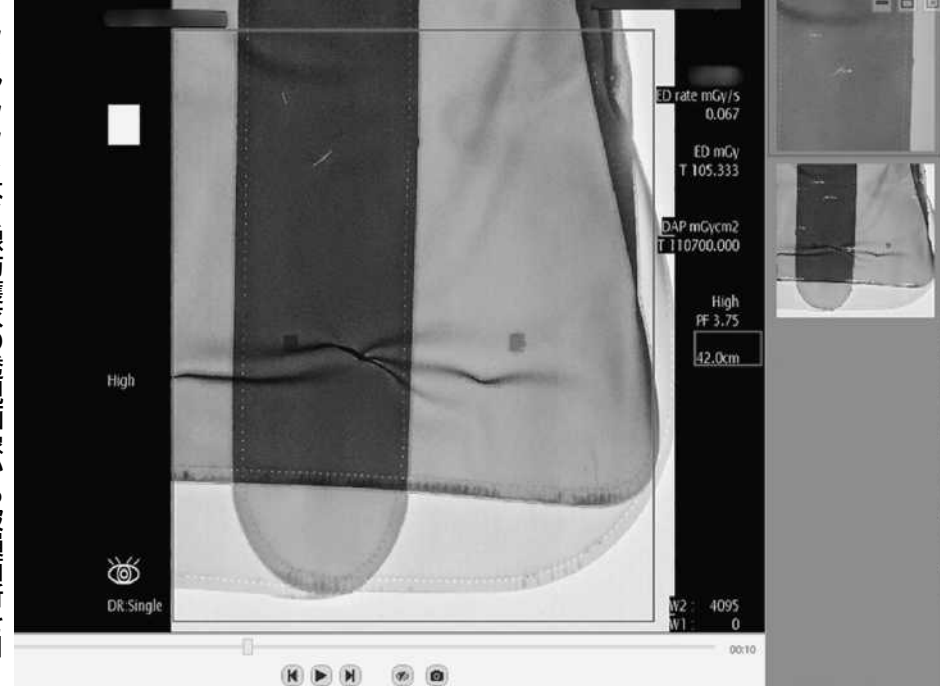
クリアタクトはX線防護衣の透視画像から破損箇所を自動で認識して検出するシステムを開発した
